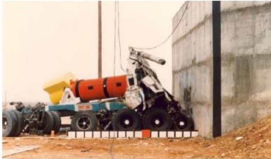
Ensayo de choque de un camión cargado con embalaje de 22 toneladas contra un muro de hormigón de 690 toneladas a 96 km/h (Sandia Nacional Laboratorios, EE.UU.).
