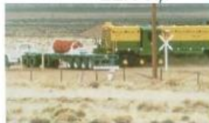
Ensayo de choque de una locomotora contra un transporte a 131 km/h (Sandia Nacional Laboratorios, EE.UU.).
