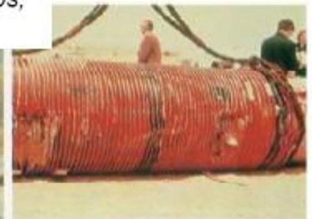
Ensayo de choque de una locomotora contra un transporte a 131 km/h (Sandia Nacional Laboratorios, EE.UU.).
