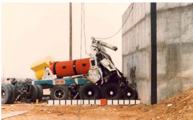
Ensayo de choque de un camión cargado con embalaje de 22 toneladas contra un muro de hormigón de 690 toneladas a 96 km/h (Sandia Nacional Laboratorios, EE.UU.).
