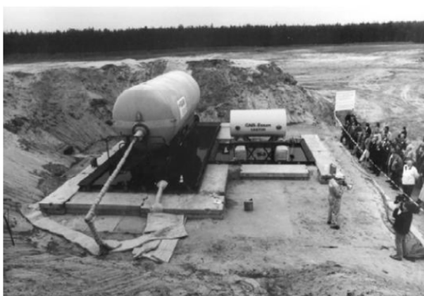
Ensayo de explosión de un tanque de propano junto a un embalaje tipo CASTOR. El embalaje sufrió un vuelco y se incrustó en el terreno (imagen de la derecha) sin llegar a sufrir daños mecánicos de importancia ni pérdida de estanqueidad (Lange y otros, 2003).
