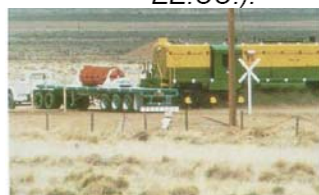
Ensayo de choque de una locomotora contra un transporte a 131 km/h (Sandia Nacional Laboratorios, EE.UU.).
