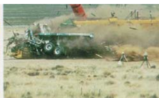
Ensayo de choque de una locomotora contra un transporte a 131 km/h (Sandia Nacional Laboratorios, EE.UU.).
