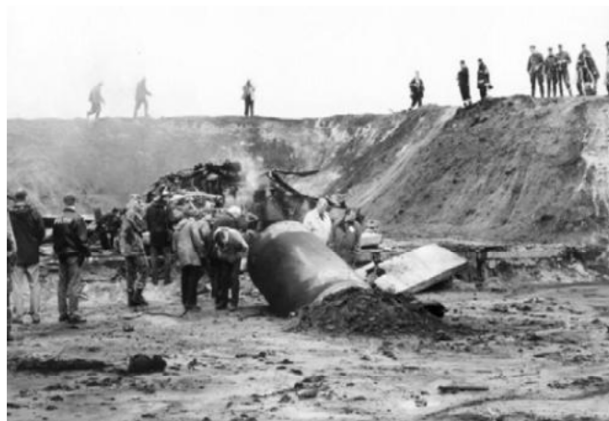
Ensayo de explosión de un tanque de propano junto a un embalaje tipo CASTOR. El embalaje sufrió un vuelco y se incrustó en el terreno (imagen de la derecha) sin llegar a sufrir daños mecánicos de importancia ni pérdida de estanqueidad (Lange y otros, 2003).
